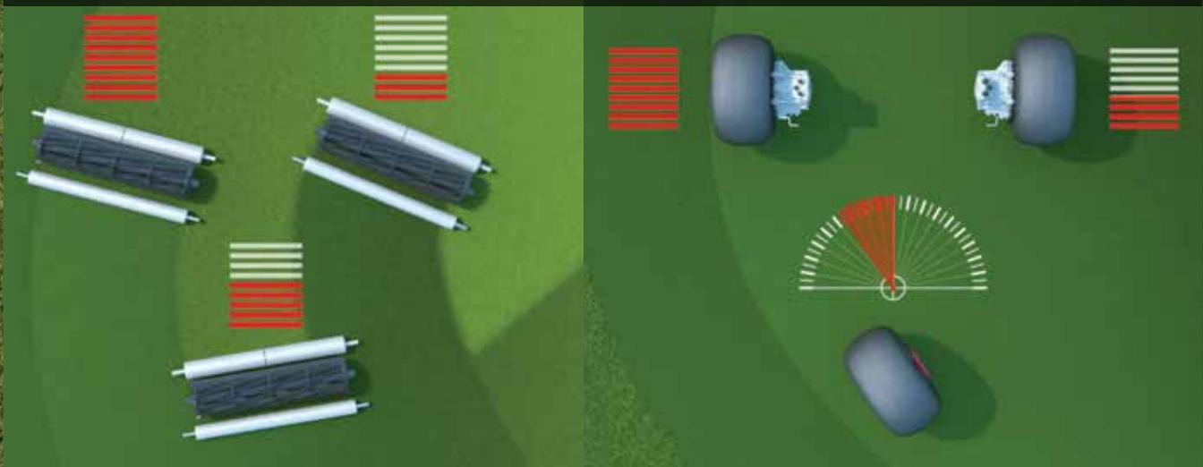
**Velocità di taglio:** Mantiene costante la velocità di taglio dell'unità in curva in ogni cilindro
