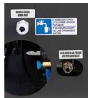
Connessioni Slip-Lock per ingresso acqua ø9,6mm e uscita acqua ø6,35mm
