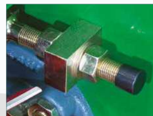
Regolazione del cilindro sulla lama inferiore con utilizzo di un'unica chiave
