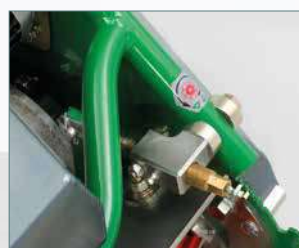
Semplice regolazione della lama inferiore al cilindro
