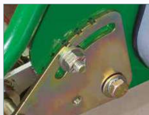
Comando preciso dell'altezza di taglio che si regola facilmente su entrambi i lati con un'unica chiave
