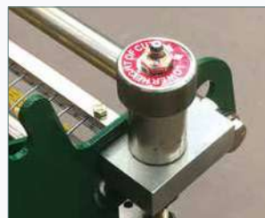
Facile regolazione dell'altezza di funzionamento senza attrezzi
