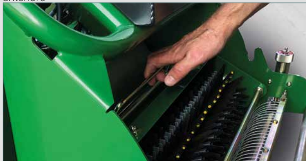
Abbassare la cassetta sulla barra di ancoraggio posteriore e farla scivolare
