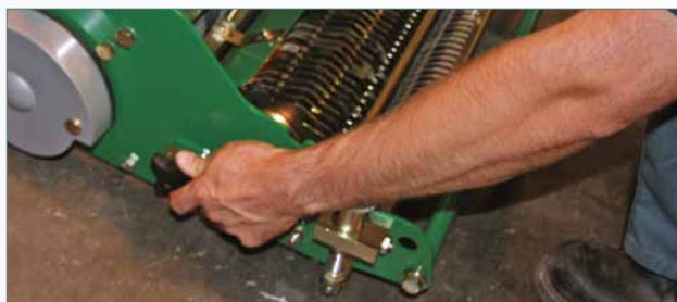
Allentare il bullone di bloccaggio e far scivolare la cassetta
