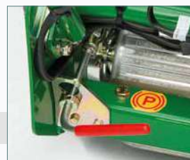
Semplice freno di stazionamento a leva
