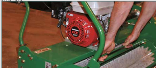
Abbassare la cassetta sulla barra di ancoraggio posteriore e farla scivolare
