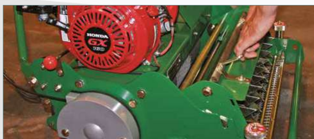
Inserire la nuova cassetta sul perno di supporto dell'unità anteriore
