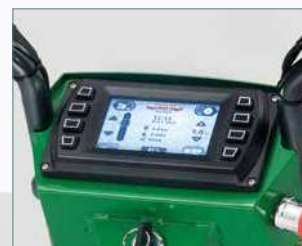
Facile controllo a schermo - carica, selezione della velocità, retromarcia, ecc.
