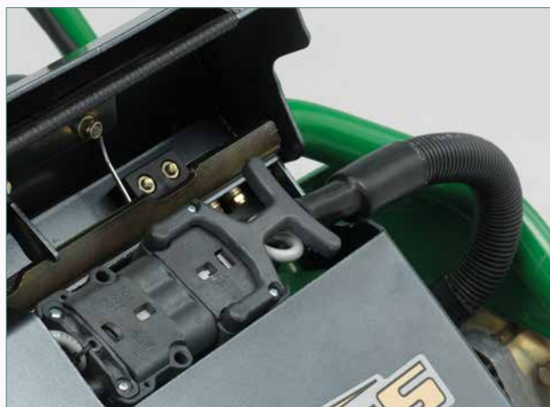
Batteria facile da collegare/scollegare al sistema elettrico
