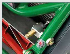
Facile regolazione della lama inferiore al cilindro
