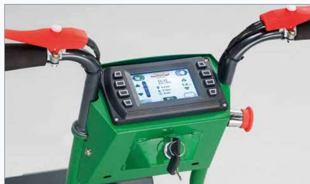
Manubrio regolabile con comandi a tastiera facili da usare
