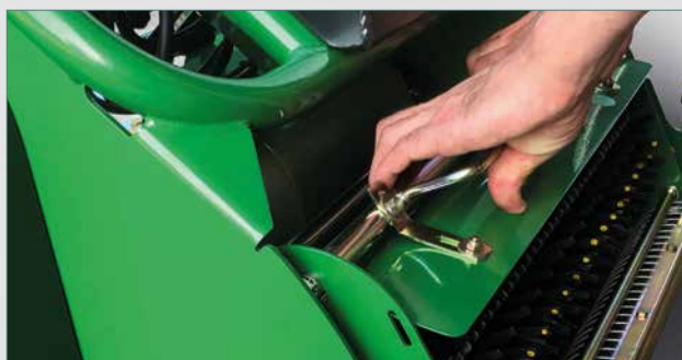
Inserire la nuova cassetta sul perno di supporto dell'unità anteriore
