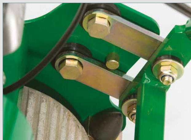
Supporti manubrio a vibrazioni ridotte per un funzionamento sicuro e confortevole
