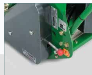
Semplice freno di stazionamento a leva
