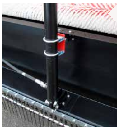
Pistone idraulico, solleva e abbassa i ranghinatori
