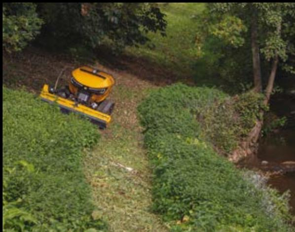
Tutti i ROBOCUT McConnel sono dotati di una tecnologia del motore sviluppata in collaborazione con i produttori OEM, specificamente per lavorare su pendenze ripide di 55 gradi, rispettando le ultime normative sulle emissioni.
