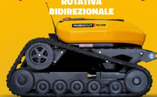
L'RC28 è dotato di una piattaforma rotante per la pacciamatura bidirezionale da 1,1 m appositamente progettata per il taglio in entrambe le direzioni. Ideale per produrre un taglio di qualità e una finitura precisa in applicazioni su campi in erba fine come parchi e giardini, mentre è abbastanza robusta da essere utilizzata per la falciatura estensiva di erba spessa.
