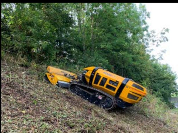
L'innovativa gamma di telecomandati McConnel si basa su un design a basso centro di gravità che lo rende ideale per affrontare le inclinazioni ripide. Ogni singolo componente è posizionato in modo speciale per garantire la migliore stabilità della macchina.
