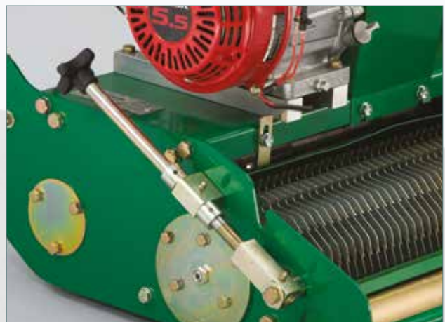
Regolazione semplice dell'altezza di funzionamento senza l'utilizzo di utensili
