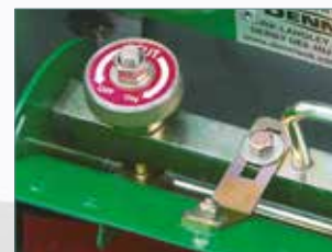
Regolazione semplice della lama inferiore sul cilindro
