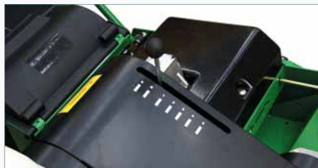
5 avanti e 1 indietro per la selezione della velocità di funzionamento
