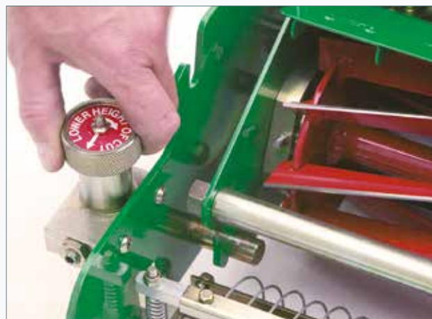
Regolazione dell'altezza del taglio pratica e semplice con incrementi di 0,25mm
