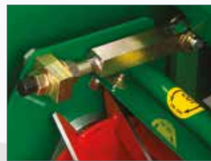
Regolazione del cilindro sulla lama inferiore agevole e pratico con utilizzo di un'unica chiave
