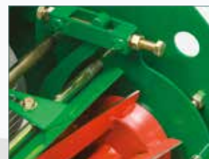
Regolazione semplice della lama inferiore sul cilindro con utilizzo di un'unica chiave
