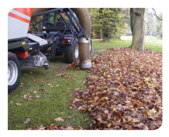
Con un tubo di aspirazione che può ruotare di 170 ° è possibile raccogliere le foglie sul lato destro e sul lato sinistro dell'SG450.
