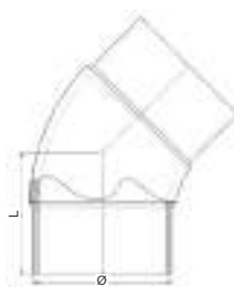
45° LONG SPIGOT ELBOW GOMITO 45° CODOLO LUNGO PE 100 SDR11 - ISO S5 (Gas) PN 16 (H2O)
