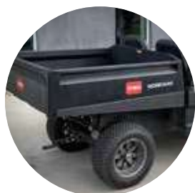
PIANALE DI CARICO DEL GTX IN ACCIAIO
