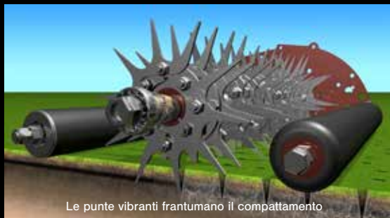
GT210 trasforma un tosaerba per green in un rapido arieggiatore dello strato superficiale
