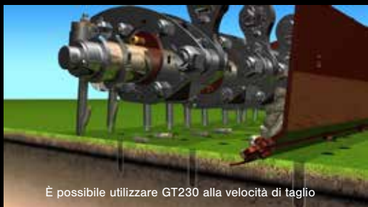
GT230 trasforma il tosaerba per green in una carotatrice
