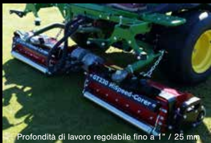
Profondità di lavoro regolabile fino a 1" / 25 mm
