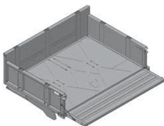
Pianale di carico opzionale, capacità di 2.041 kg
