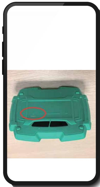
**3.** Svitare il coperchio della batteria del sensore e installare le batterie nel sensore restando vicini a EM-WF. Dopo aver installato le batterie, il LED VERDE si accenderà per alcuni secondi.
