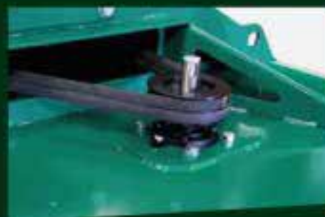
TRASMISSIONE A DOPPIA CINGHIA – PER GESTIRE GRANDI VOLUMI DI ERBA
