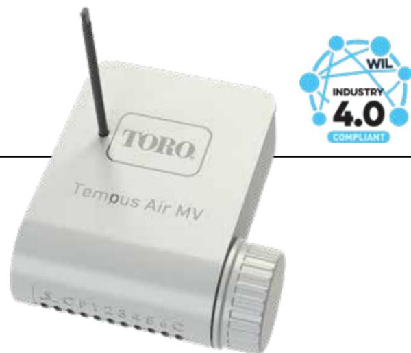
**Modulo centralina a batteria, IP68, per gestire una Master Valvola (o un comando pompa) dotato di ingresso per sensore pioggia o volumetrico, radio comandabile attraverso protocollo LoRa™.**
