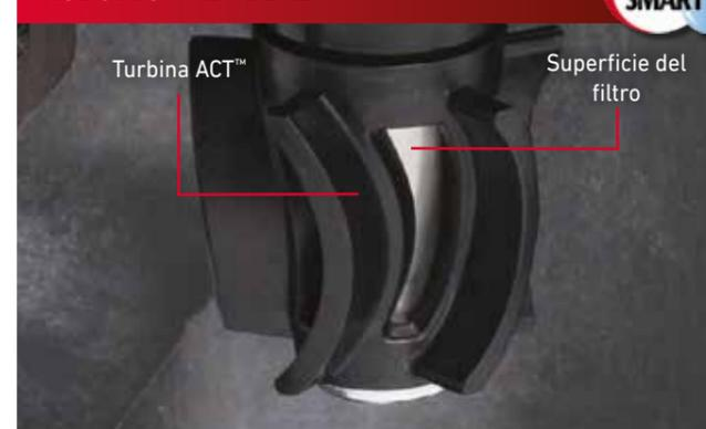
Le valvole Serie Scrubber P-220S presentano il sistema Toro ACT™ (Active Cleansing Technology) brevettato. La robusta turbina del sistema ACT è in costante rotazione, il che, a sua volta, mantiene l'area di misurazione e filtraggio priva di accumuli di sporcizia e alghe. La turbina è realizzata con materiali resistenti a clorina, clorammina e ozono, mantenendo la valvola operativa a prestazioni ottimali.
