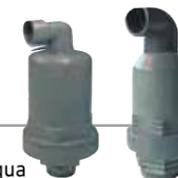
La fase di sfiato finisce appena l'acqua arriva all'interno della valvola sollevando il galleggiante e chiudendo l'orifizio d'uscita. All'arresto del sistema la valvola impedisce il collasso del tubo permettendo che l'aria nell'impianto riassuma una pressione pari a zero.
